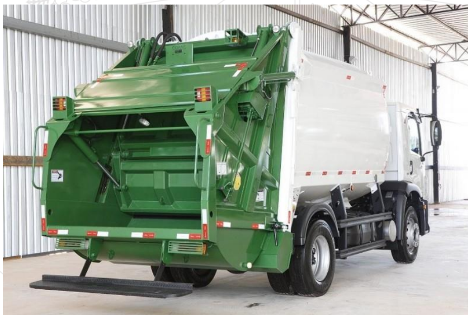
Figura 03 – Ilustração - Modelo de equipamento para coleta de resíduos sólidos domiciliares em área urbana.
