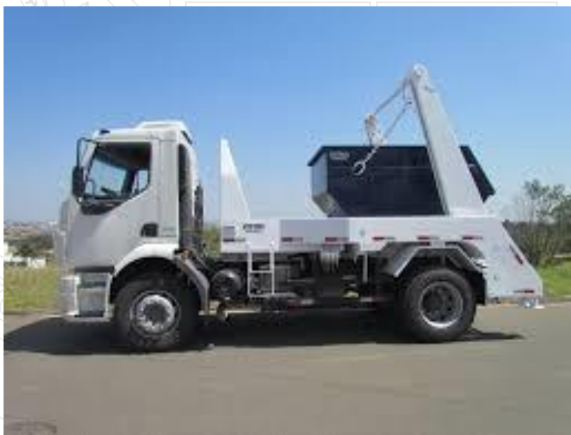
Figura 05 – Ilustração - Modelo de equipamento, caminhão poliguindaste, utilizados em serviços de coleta mecanizada.
