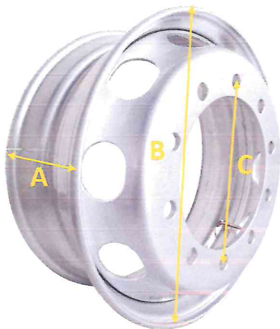
Figura 2 – Descrição especificações das rodas.
