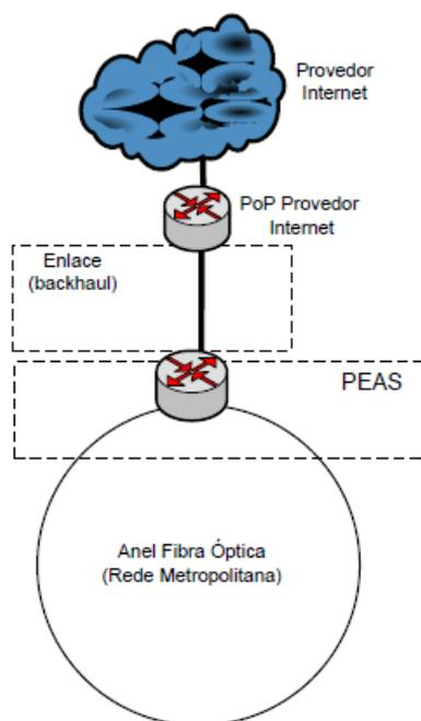
Figura 1 – Topologia de interconexão.
