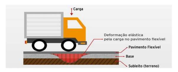
Figura 1 – Deformação Elástica de Carga no Pavimento Flexível. Fonte: CNT (2017).
