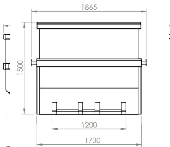
Figura 2 - Dimensões da caçamba estacionária, peso de 675 kg, capacidade de carga de 7 m<sup>3</sup>.
