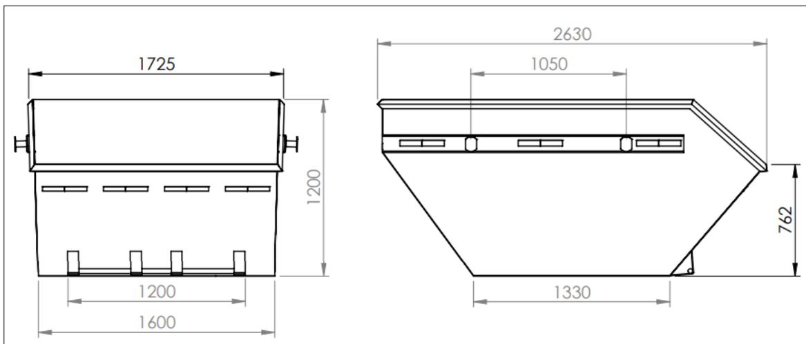
Figura 1 - Dimensões da caçamba estacionária, peso de 362 kg, capacidade de carga de 5 m<sup>3</sup>.
