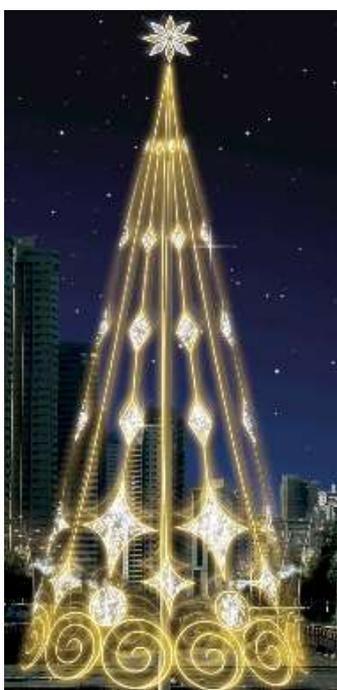
16 Figuras luminosa bidimensional com desenho em forma espiral, medindo 1,60m de altura x 1,60m de largura, com estrutura de barra chata de alumínio de 1/2", e contorno duplo de mangueira luminosa transparente flexlight LED com 13mm de diâmetro e 36 LEDs por metro e dispostos na horizontal (paralelos ao eixo da mangueira) que permite a ampla iluminação independente de posição da mangueira nas peças, na cor Branco Morno 3000K. Consumo 32w, 220 volts.
