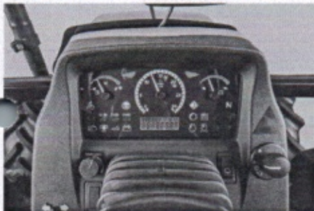
Painel de instrumentos da transmissão 12x12
