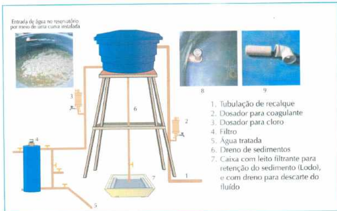
Figura 1 – Solução Alternativa de Tratamento de Água (SALTA-z).
