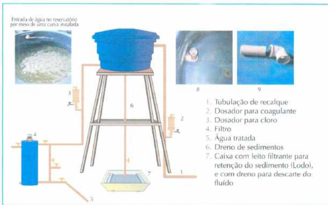
Figura 1 – Solução Alternativa de Tratamento de Água (SALTA-z).
