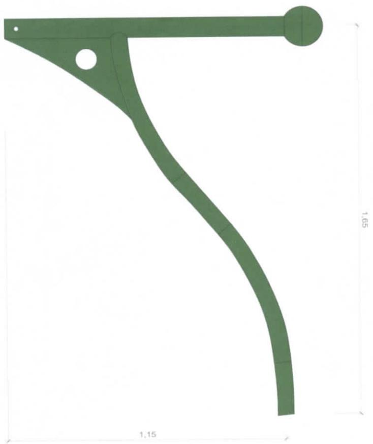
BRAÇO PARA ILUMINAÇÃO PÚBLICA CURVO S/ SAPATA GALVANIZADO A FOGO
