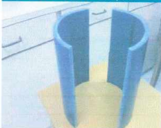
Chapa para espalmar o tubo PVC
