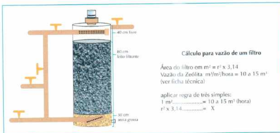
Figura 2 – Visão interna do filtro com as medidas do leito filtrante.
