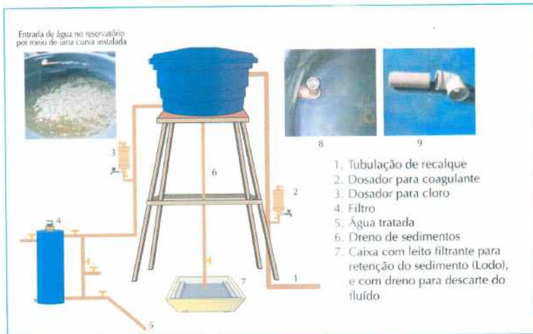
Figura 1 – Solução Alternativa de Tratamento de Água (SALTA-z).
