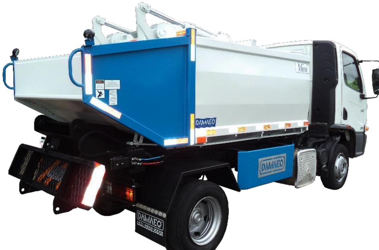
Coletor novo, de fabricação nacional, com capacidade para 4 m<sup>3</sup> - 5m<sup>3</sup>, teto em chapa lisa, laterais em chapa única calandrada, descarga por basculamento da caixa coletora, estanque permitindo a contenção e coleta do chorume, com cilindros de dupla ação e sistema de carregamento traseiro, com compactação por placa pendular, acionada por cilindros de compactação com diâmetro de 2.1/2".
