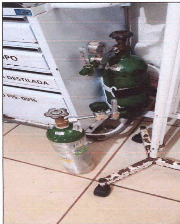
Figura 2. Cilindro de gás medicinal enferrujado – UBS Tropical.
