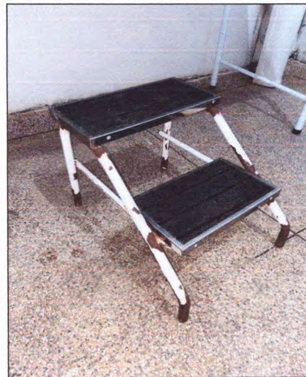
Figura 4. Escada dois degraus enferrujada – UBS Altamira.
