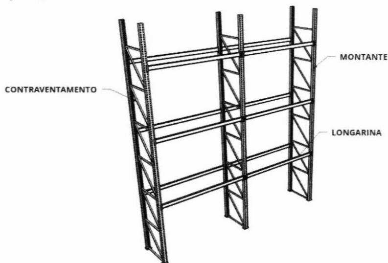
Figura 01 – Elementos básicos que compõe a estrutura porta-paletes.
