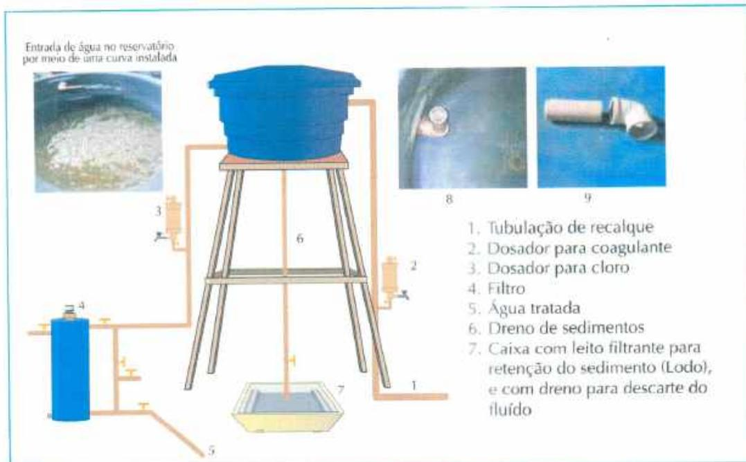
**Figura 1** – Solução Alternativa de Tratamento de Água (SALTA-z).
