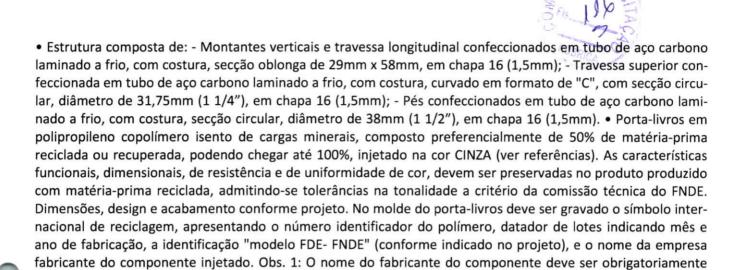
grafado por extenso, acompanhado ou não de sua própria logomarca. • Fixação do tampo à estrutura através de: - 06 porcas com rosca métrica M6 (diâmetro de 6mm), Co injetadas em castelos troncocônicos do próprio tampo; - 06 parafusos rosca métrica M6 (diâmetro de 6mm), comprimento 47mm, cabeça panela, fenda Phillips.
