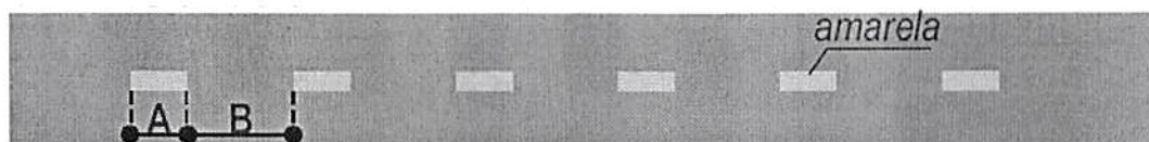
Detalhe Faixa Seccionada.
