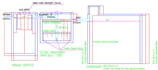
02 TANQUE SÉPTICO, FILTRO e SUMIDOURO - CORTE
