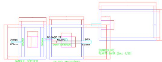
01 TANQUE SÉPTICO, FILTRO e SUMIDOURO - PLANTA BAIXA
