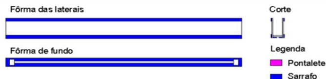
Figura 2: Fabricação de fôrma de viga interna (compensado)
