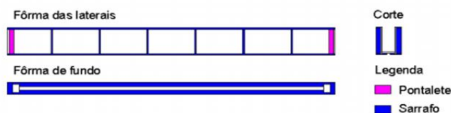
Figura a seguir: Fabricação de fôrma viga externa (compensado)
