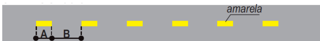
Detalhe Faixa Seccionada.
