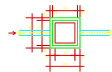
CAP - CAIXA DE ÁGUAS PLUVIAIS
