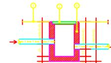
CAP - CAIXA DE ÁGUAS PLUVIAIS
