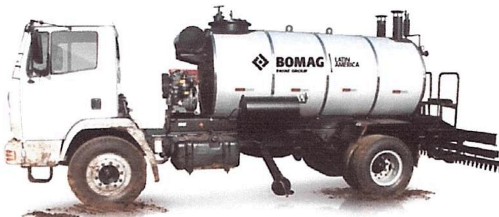
Os Espargidores Bomag HE - C 6000L, com preciso sistema pneumático de operação, são eficientes e tem grande uniformidade de vazão nos bicos, o que garante as taxas de aplicação especificadas. Ideais para a distribuição de betume asfáltico em serviços de construção de pavimentos rodoviários e indicados para operar com emulsões asfálticas (com ou sem polímeros), asfaltos diluídos ou CAPs.
