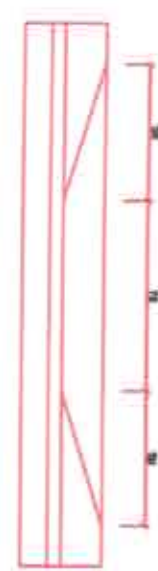
DETALHE DO MEIO FIO C/ REBAIXO Escala: 1/20
