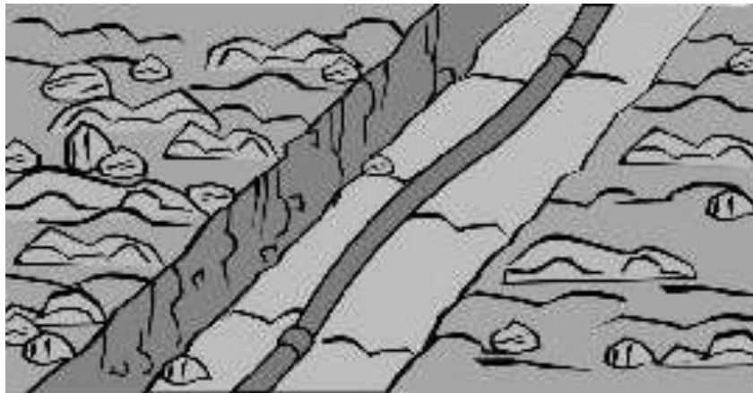
Exemplo de assentamento de tubulação enterrada.
