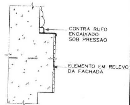
ARREIMATE DE ELEMENTO EM RELEVO DA FACHADA
