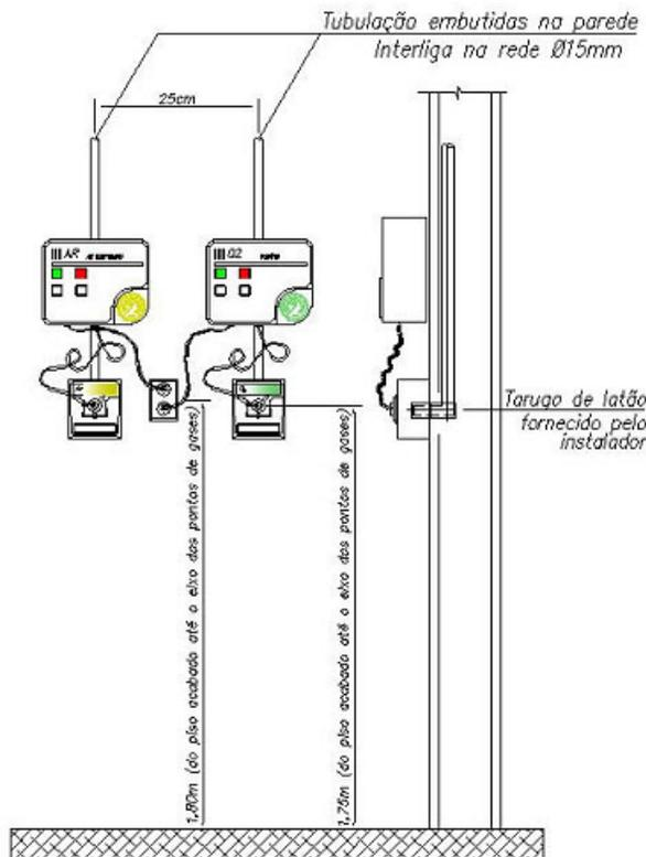
*Detalhe Típico dos Painéis de Alarme
