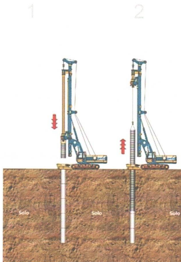
Figura 1: Processo de retirada das barras de aço.
