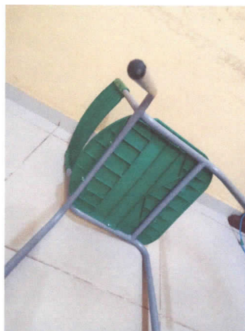
Ausência de buchas plásticas em pp cor verde
