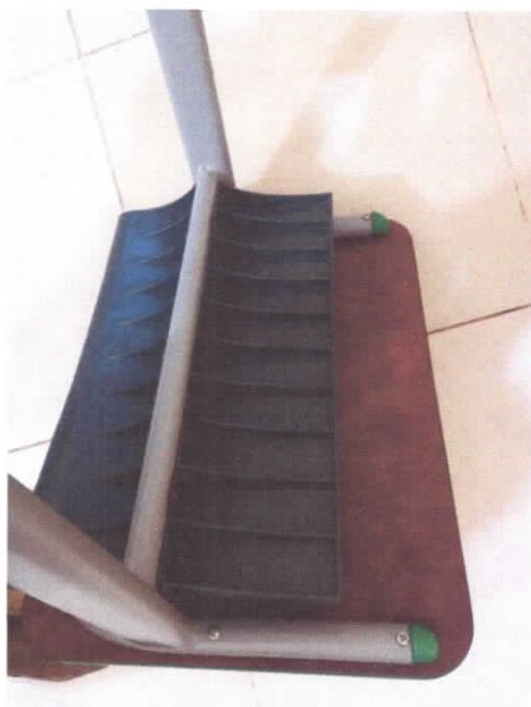
Ausência de tampo em ABS
