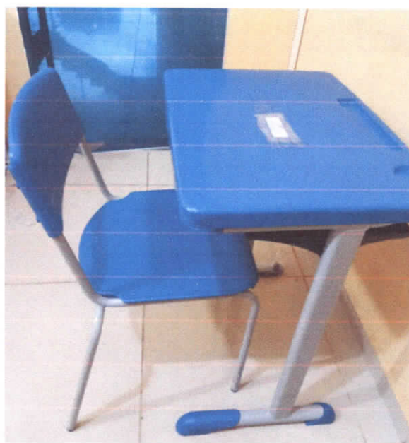
Ausência de Laminado melmínico na face superior.
