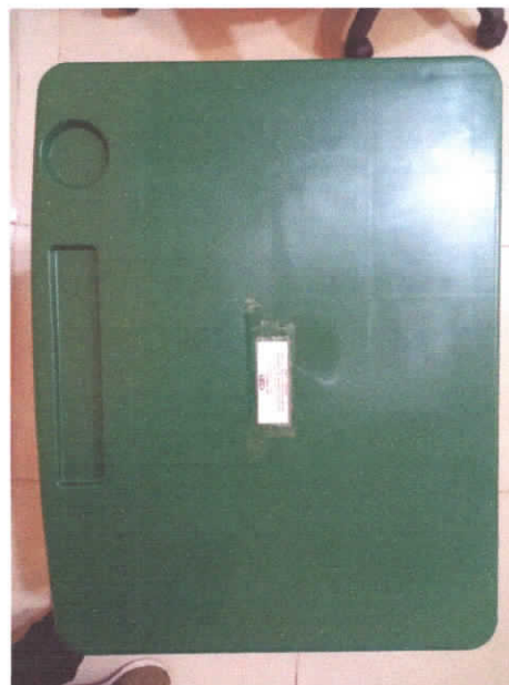
Ausência de Laminado melmínico na face superior.
