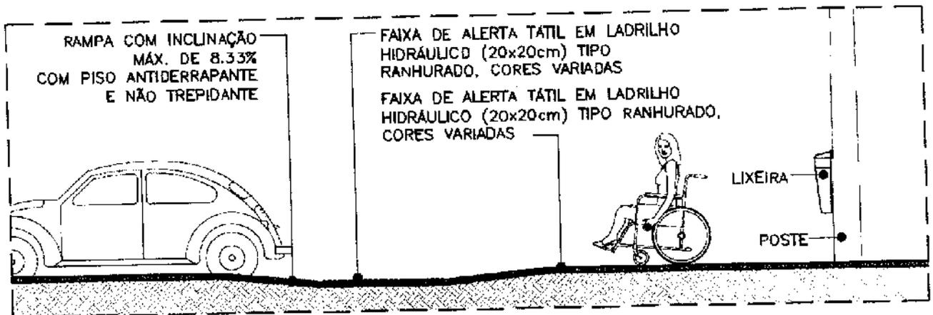
Em esquinas, devem-se posicionar as rampas de acesso aos pedestres fora da curvatura, sempre em concordância com as faixas de travessia implantadas. Quando não houver espaço suficiente para a existência da rampa com inclinação adequada e faixa de percurso de no mínimo 1,20 m, que permita manobra do cadeirante em frente à rampa, recomenda-se rebaixar toda a largura da calçada.
