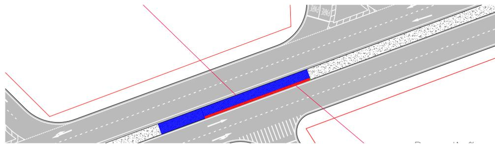
**DETALHE "F" - REMOÇÃO DA CAMADA DE ASFALTO PARA CONSTRUÇÃO DA ROTATÓRIA E CONSTRUÇÃO DE CANTEIRO CENTRAL. O CANTEIRO EXISTENTE NA ÁREA DA ROTATÓRIA DEVERÁ SER DEMOLIDO**
