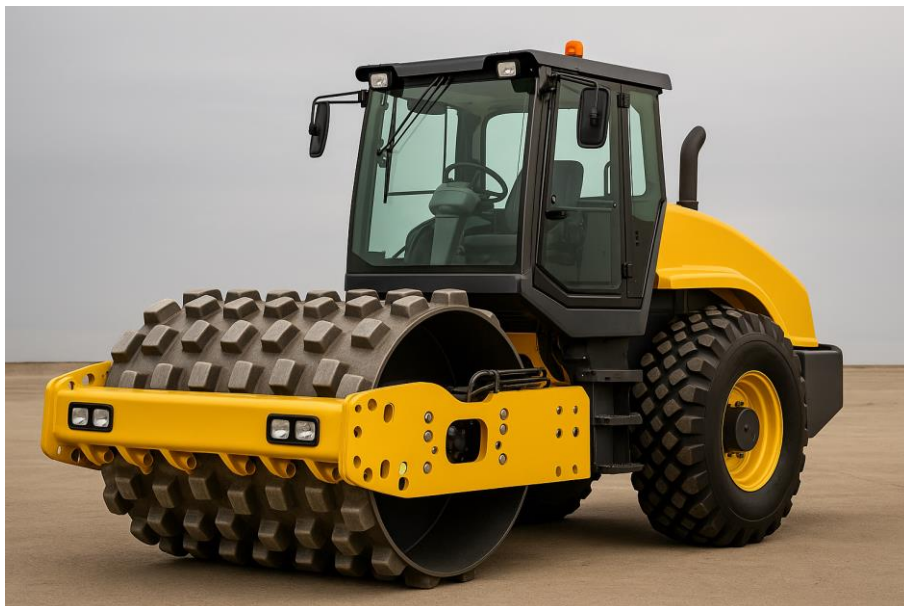
ROLO COMPACTADOR COM TAMBOR CONVERTIDO PARA PÉ DE CARNEIRO
