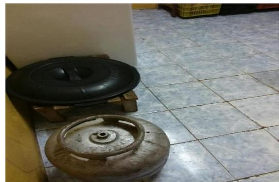
Botijão de gás em ambiente interno e inadequado
