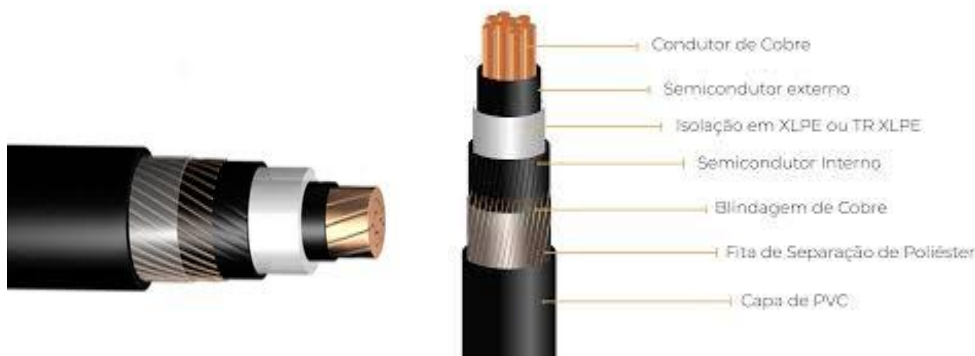
Imagem 7 - Cabeamento de Média Tensão
