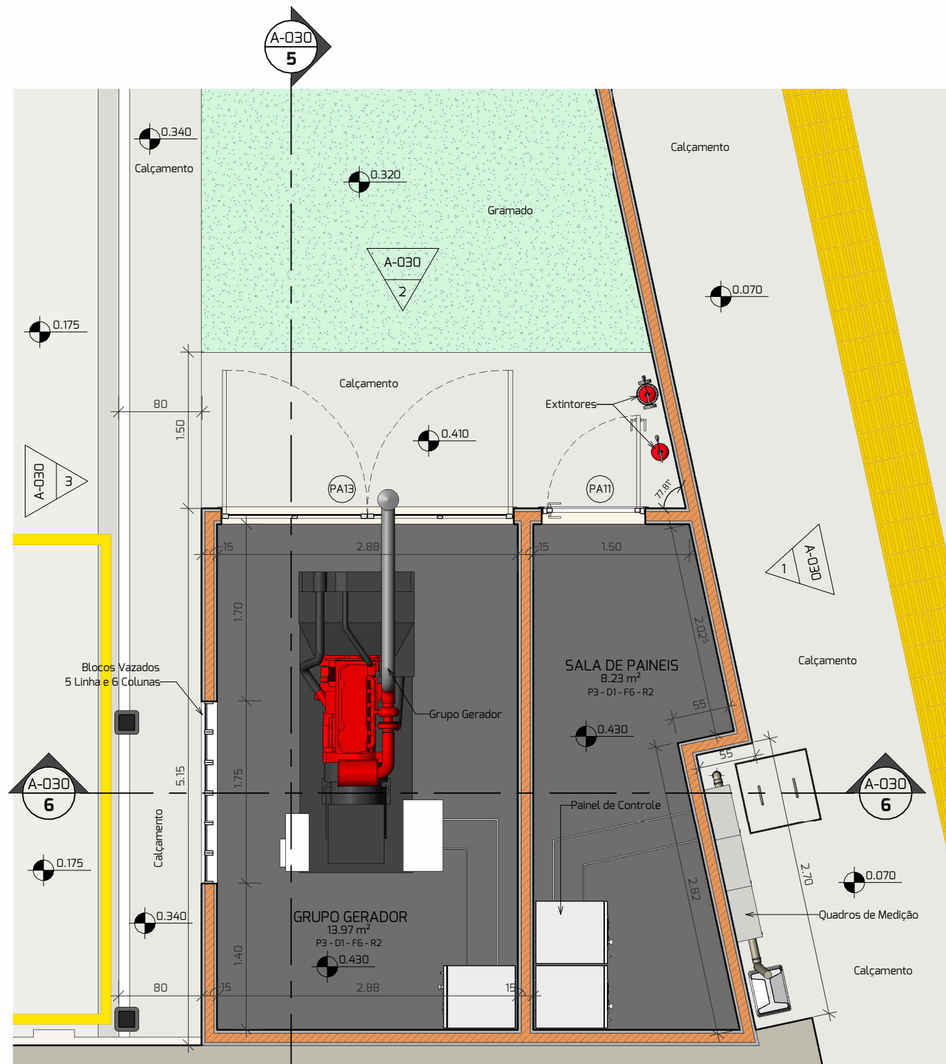
4 SUBESTAÇÃO - PLANTA BAIXA ESCALA 1: 50
